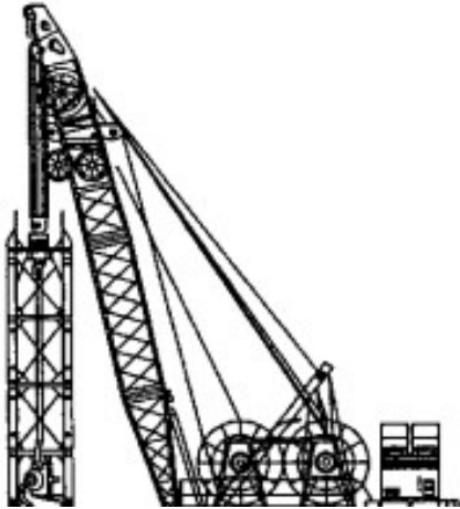
Hình A.3.3 Máy thi công tường trong đất với cụm công tác kiểu bánh phay không có dẫn hướng.
